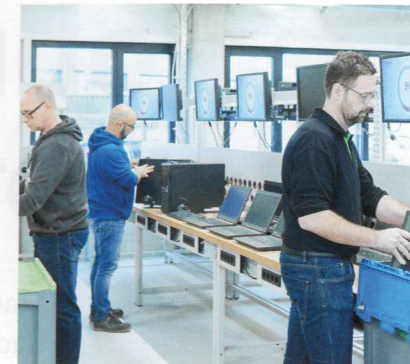
AfB-Mitarbeiter im der Ettlinger Niederlassung löschen erst vollständig die Daten, bevor sie testen, ob die Geräte – hier Laptops – noch gut funktionieren. Auf den Bildschirmen oben ist zu sehen, wie viel Prozent bereits gelöscht wurden. Dass alle vier Bildschirme die gleiche Prozentzahl anzeigen liegt daran, dass das Löschen bei allen Laptops gleichzeitig begann.
